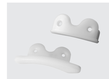
für Profil 1.80R Kunststoff Nutenbreite mind. 27 mm seitlicher Auftrag: 7,5 mm 2 Bohrungen 4,2 Ø passende U-Profile: 1.1371 / 1.1372 1.1373 / 1.1377
