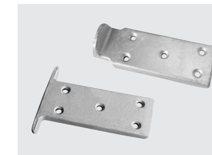
für Profil 1.100D/ISO-Plus/1.D06 Stahl, geschmiedet Nutenbreite mind. 25 mm seitlicher Auftrag: 10 mm bei Sturmhaken: 30 mm 5 Bohrungen 6,7 Ø passende U-Profile: 1.1340 / 1.1351 / 1.1371 1.1372 / 1.1373 / 1.1377 1.1370 (bei Sturmhaken)
