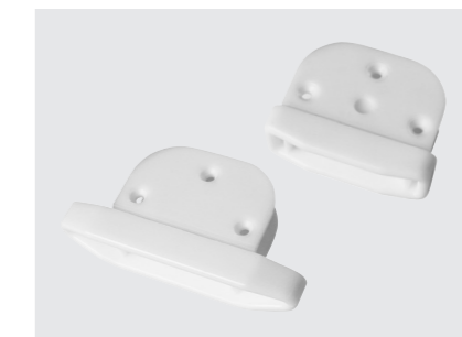
für Profil 1.100D/ISO-Plus/1.D06 Kunststoff Nutenbreite mind. 27 mm seitlicher Auftrag: 15 mm bei Sturmhaken: 30 mm 3 Bohrungen 4,2 Ø passende U-Profile: 1.1350 / 1.1351 1.1371 / 1.1372 (o. SchleiBlappen empfehlenswert) 1.1373 / 1.1377 1.1370 (bei Sturmhaken)
