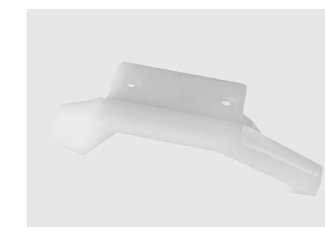
für Profil 1.1590 ISO Kunststoff Nutenbreite mind. 36 mm seitlicher Auftrag: 13 mm bei Sturmhaken: 26 mm 3 Bohrungen 5,2 Ø passende U-Profile: 1.1397 / 1.1378 1.1370 (bei Sturmhaken)
