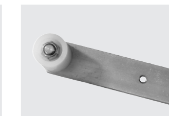
Rollensturmhaken für Profil 1.100D/1.1590/1.1460 Flacheisen: 40 x 8 mm Flachhalbrund: 50 x 13 mm seitl. Auftrag: 60 mm Rolle: 35 mm Ø Rolle: hoch 48 mm 4 Bohrungen 7 Ø
